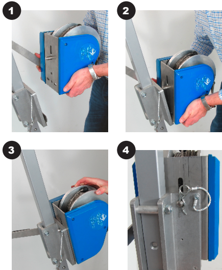
Példa alkalmazásra IKAR DB-A2 típusú háromlábú mentőáll-
